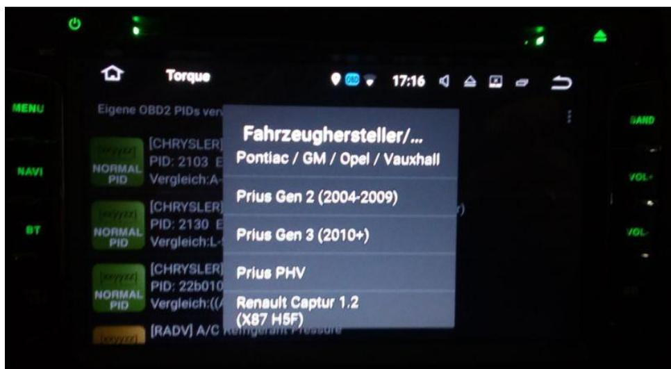
Nun zurück zum Hauptmenü und auf Echtzeit Informationen klicken. Dort können dann die Pids hinzugefügt werden. Als Hilfe werden die PIDs die von der ECU unterstützt werden Grün hinterlegt. Dazu einfach länger auf den Bildschirm klicken und Anzeige hinzufügen auswählen. Nun hat man die Möglichkeit die Form der Anzeige auszuwählen. Je nach Wert machen unterschiedliche Anzeigeformate Sinn.
