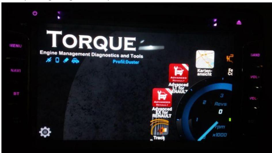
Den Button Advanced EX for Renault auswählen und das Fahrzeug mit wenigstens ähnlichen Motoreigenschaften auswählen. (Dazu hilft auch der angegebene Motorcode) Anschließend wieder im Hauptmenü das Zahnrad anklicken und auf Einstellungen klicken. Da dann runter scrollen und auf
